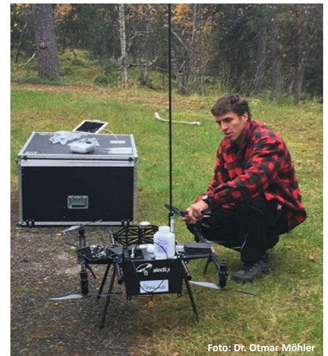
Drohnenpilot Gerd Schaufelberger mit dem Fidas® Fly und HORUS Multikopter von Airclip
